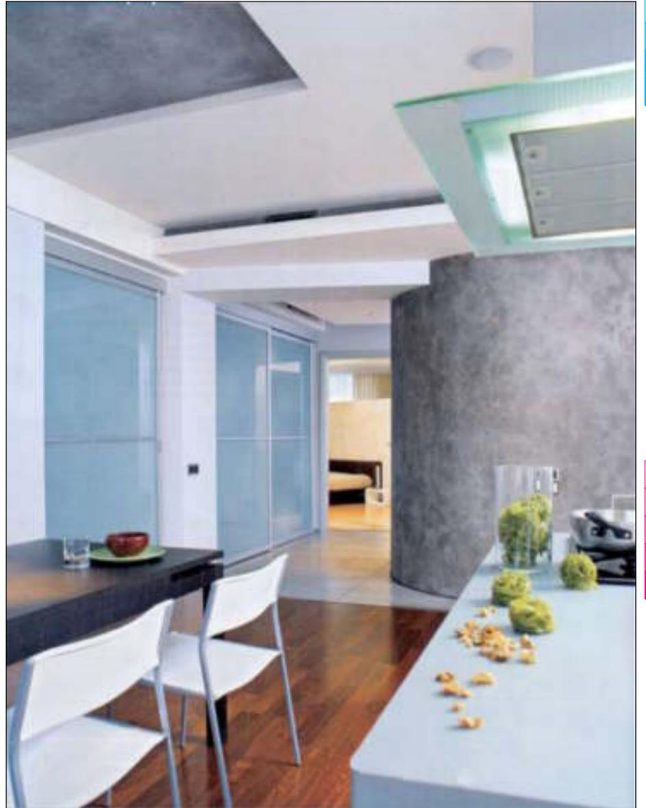
За подвесным потолком проходят воздуховоды, в нем же установлены вентиляционные решетки
