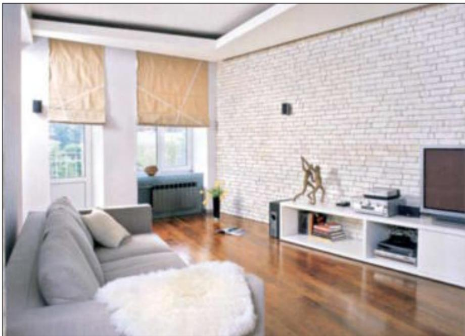
Стена напротив дивана облицована гипсовой плиткой, имитирующей кирпичную кладку с характерными для нее швами
